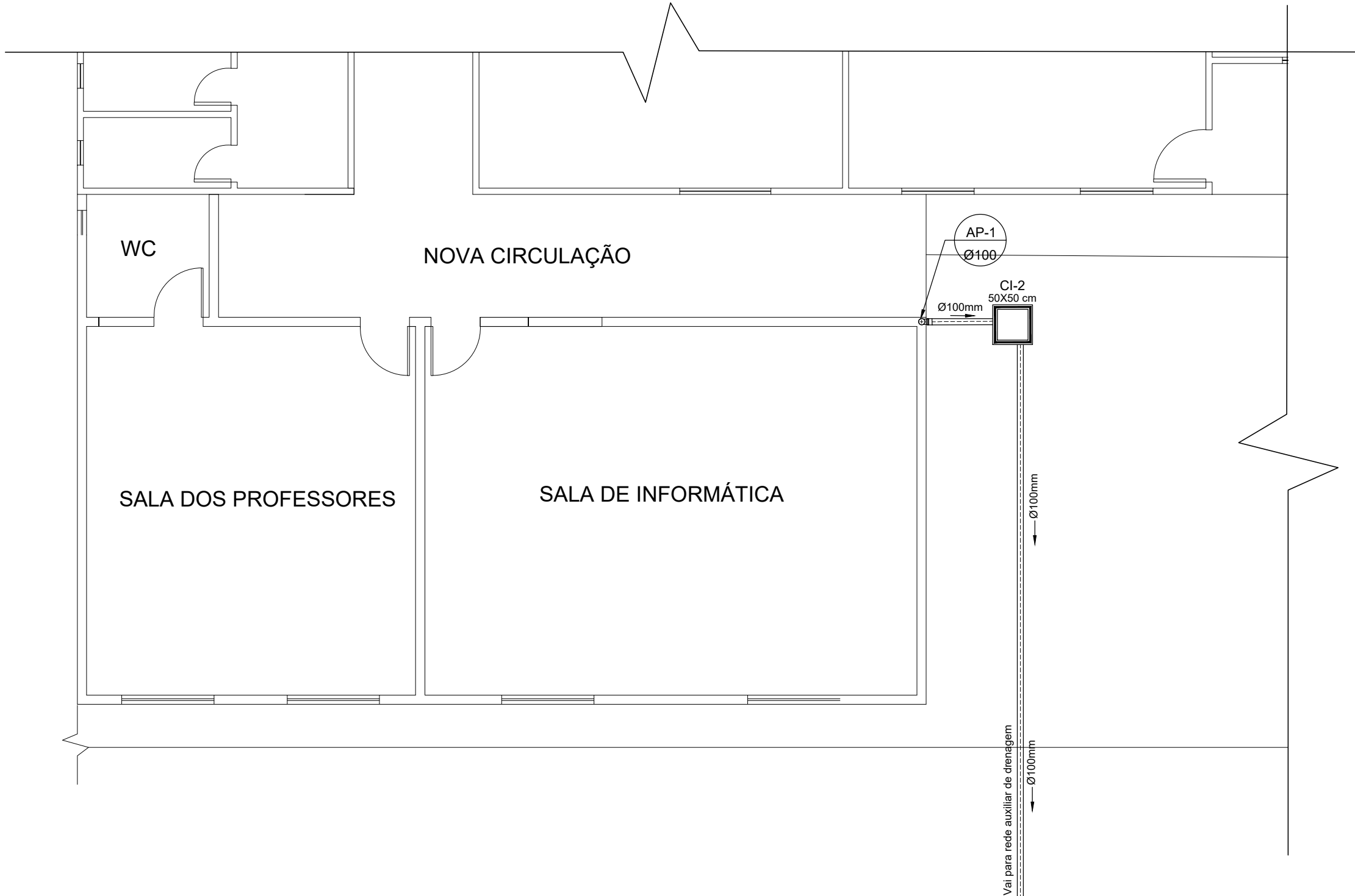
DRENAGEM PLUVIAL - PLANTA BAIXA NOVO BLOCOS DE SALAS ESC. 1:75
