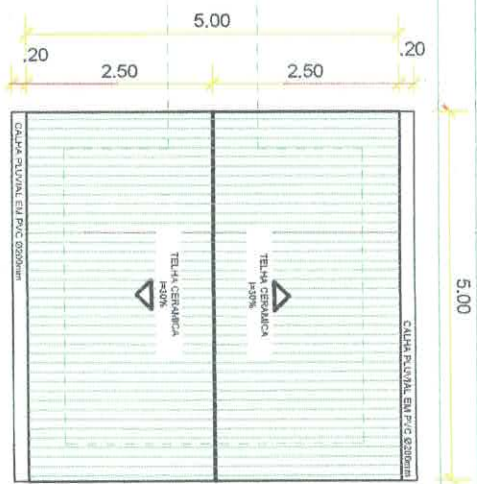
PLANTA COBERTURA ESC 1/100
