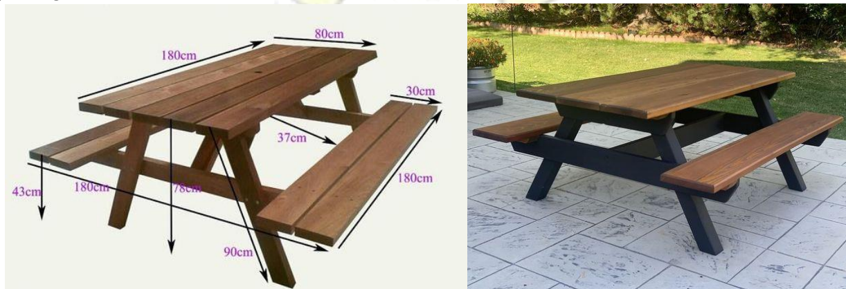
Figura Esq. – Dimensões sugeridas para a execução da Mesa de Picnic / Figura Dir. – Acabamento final da Mesa de Picnic
