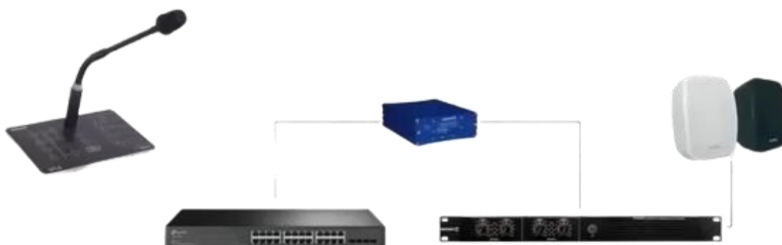
Figura 9 - Esquema de ligação de som por IP
