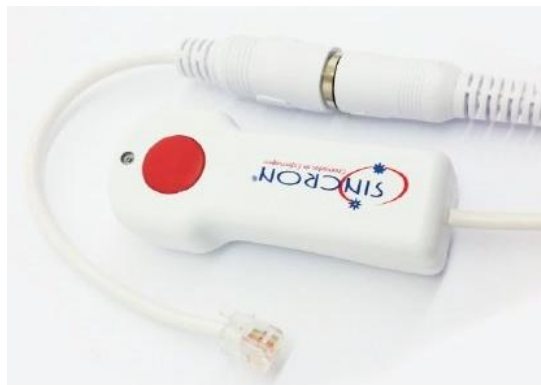
Figura 7 - Pêra de acionamento de chamada de Enfermagem
