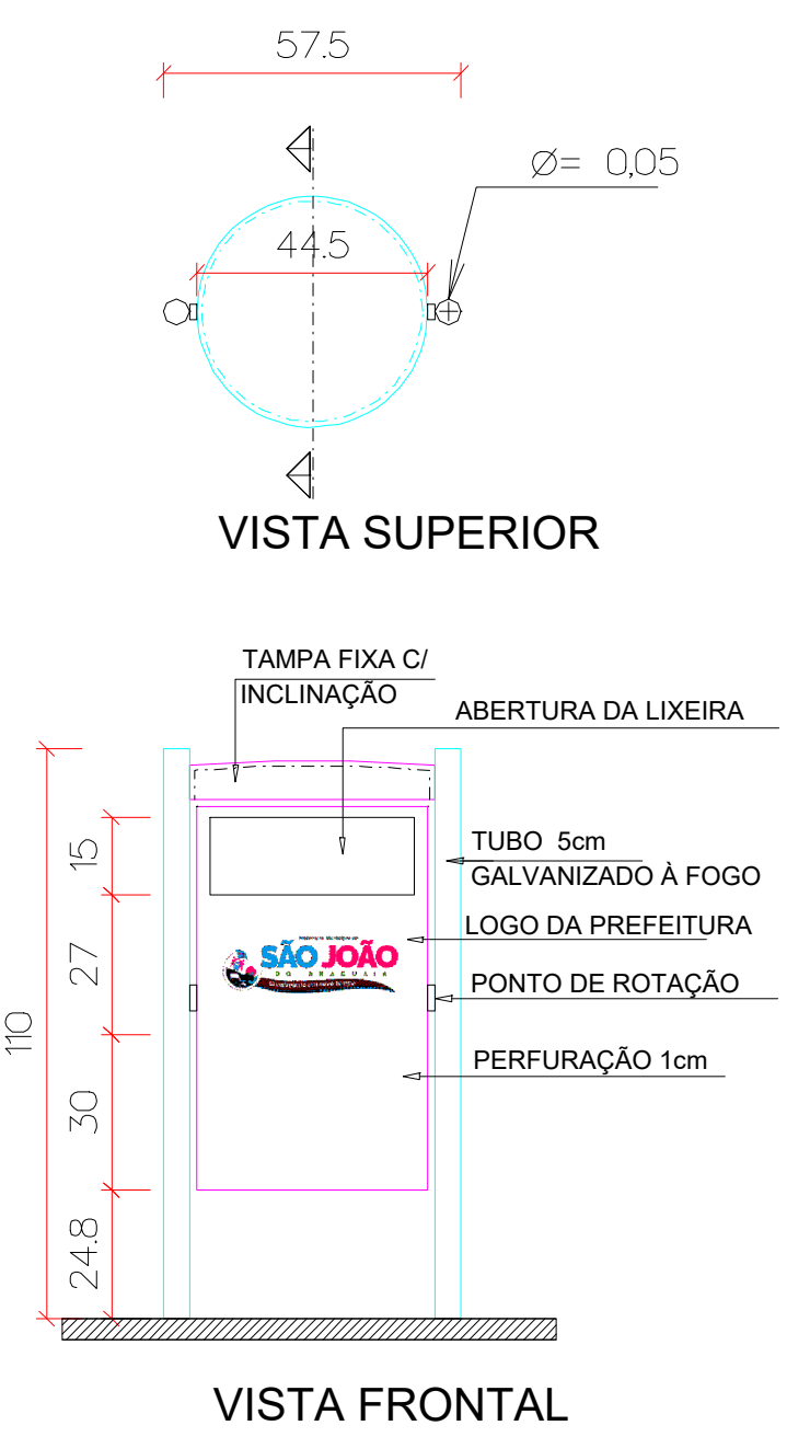
DETALHE 05 - LIXEIRA METÁLICA ESCALA 1:20
