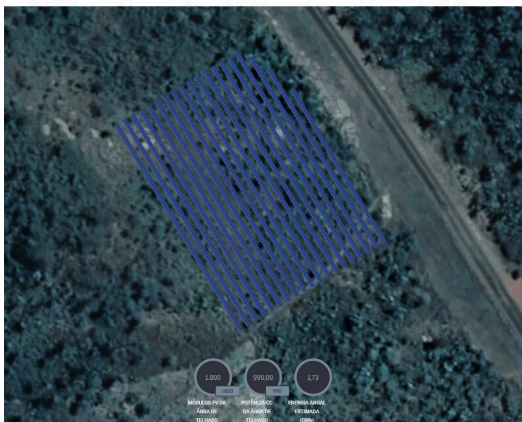
Figura 2- Usina de solo de 990 kWp ao lado da MA-349
