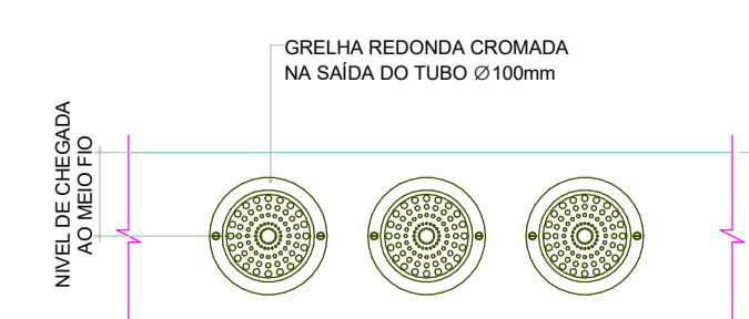
DETALHE-03 SAIDA DO TUBO PVC Ø100 NA SARJETA ESCALA:1/10
