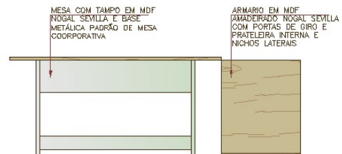
M-07 - DETALHAMENTO - VISTA 01 esc 1:25
