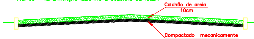
FIG. 03 - IMPLANTAÇÃO MEIO FIO E COLCHÃO DE AREIA
