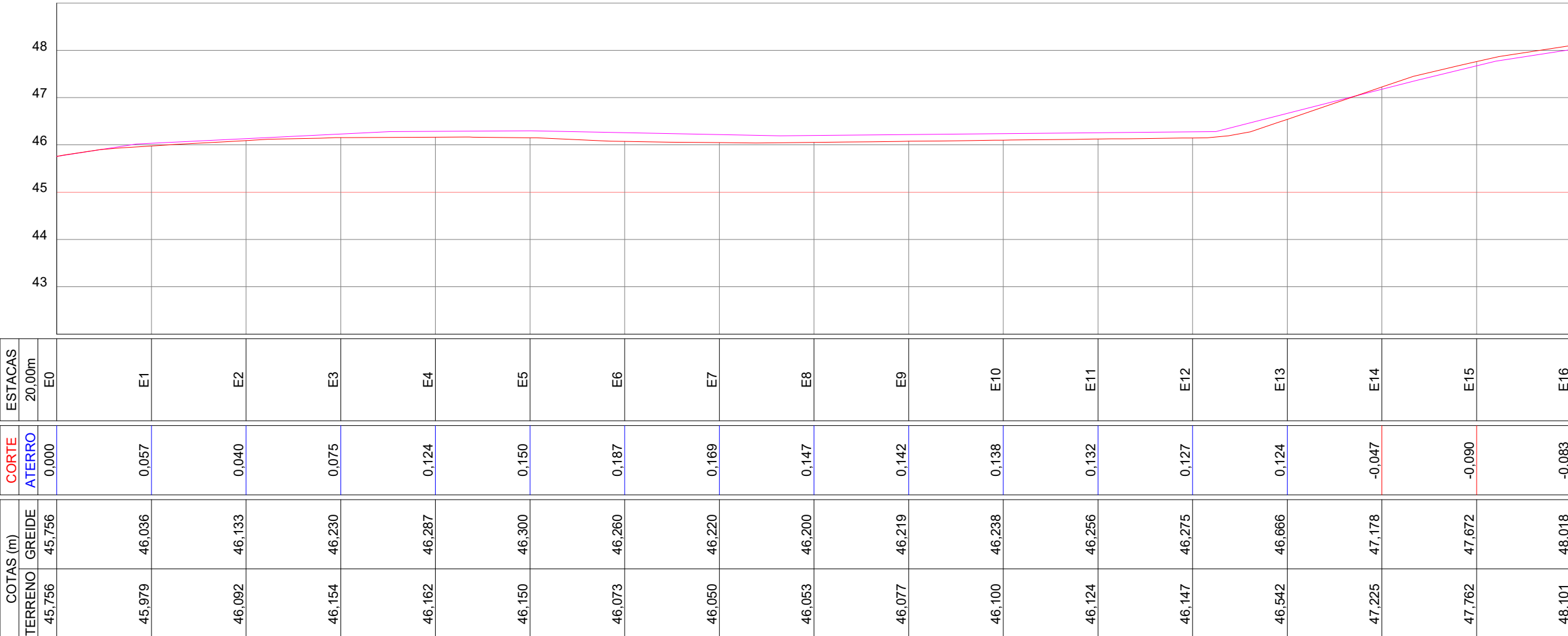
PERFIL LONGITUDINAL RUA PICOS ESCALA VERTICAL 1/100 ESCALA HORIZONTAL 1/1000
