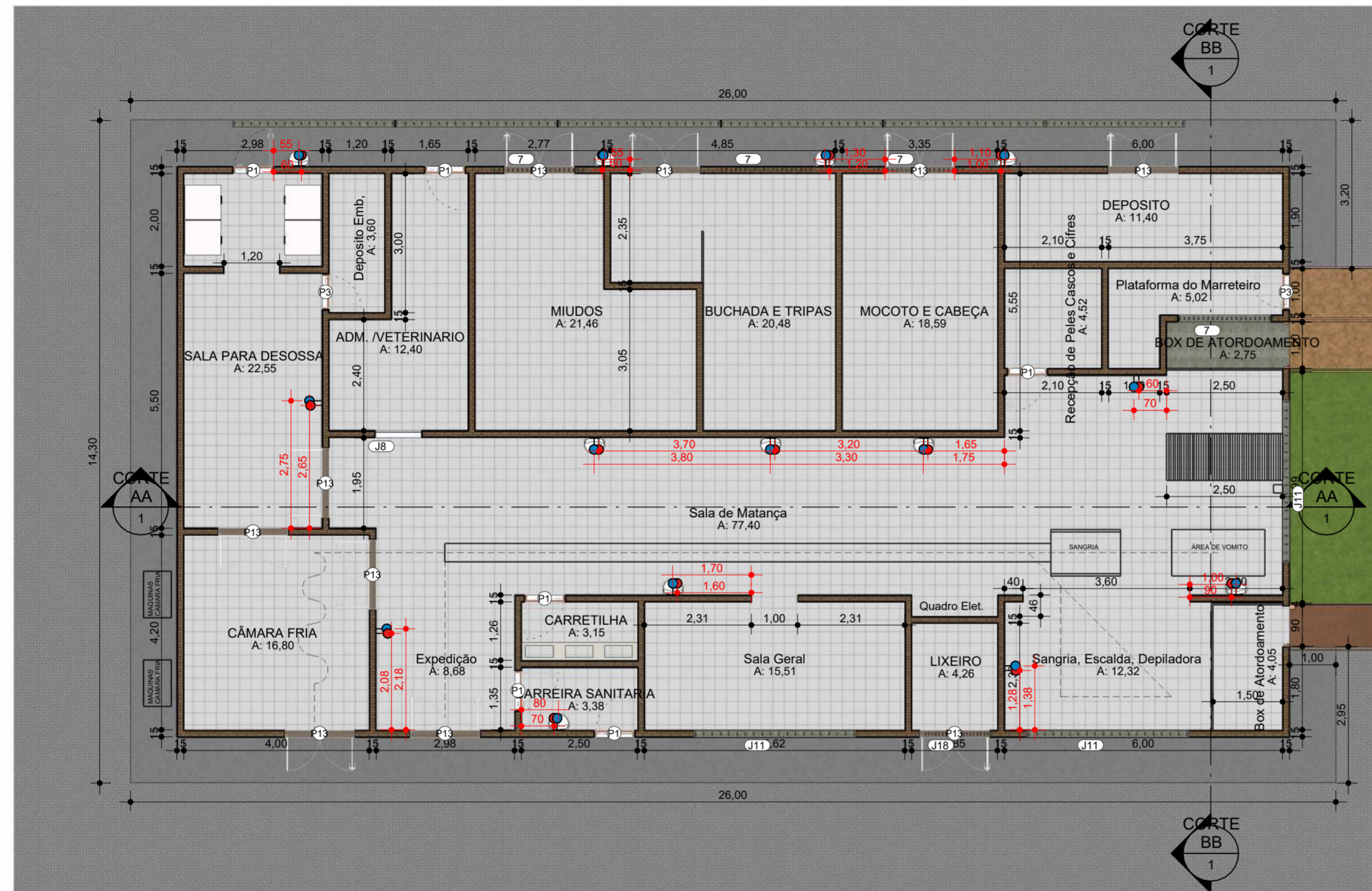
1 PLANTA BAIXA TÉRREO MATADOURO 1:100 PONTOS HIDROSSANITÁRIOS
