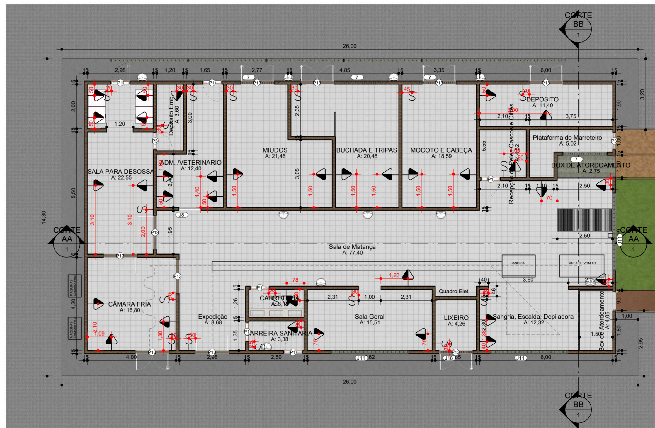
1 PLANTA BAIXA TÉRREO MATADOURO PONTOS ELÉTRICOS 1:100
