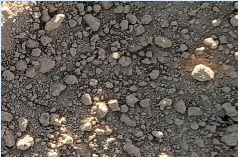
Areia siltosa de cor amarronzada medianamente compactada com presença de quartzo(seixo)
