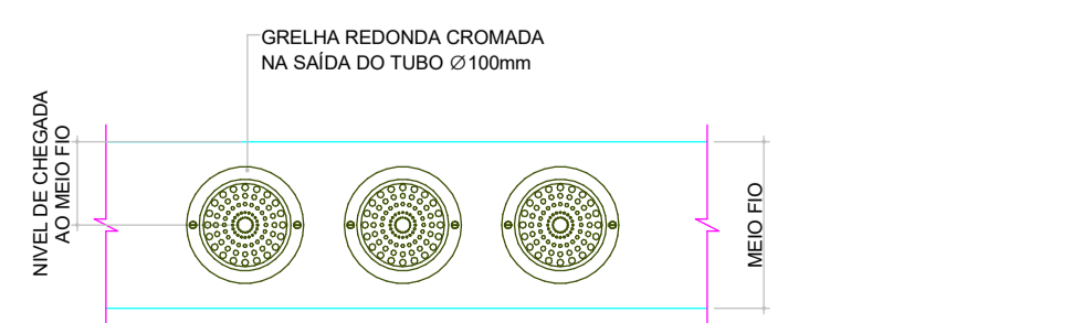
DETALHE-03 SAIDA DO TUBO PVC Ø100 NA SARJETA ESCALA: 1/10
