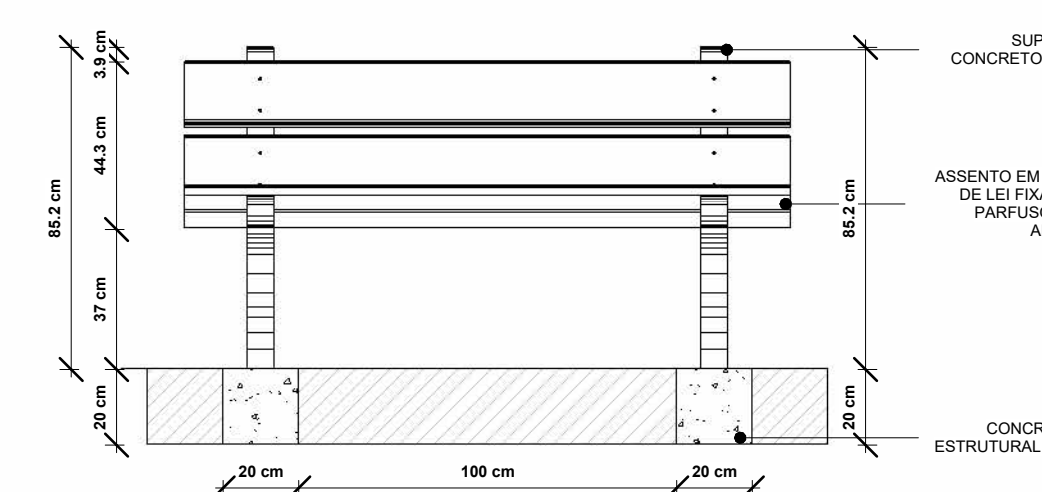
13 DETALHAMENTO BANCO - VISTA FRONTAL ESCALA 1:20
