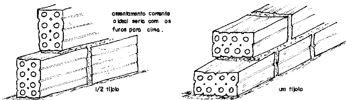
Figura 1 - Execução de alvenaria utilizando tijolos furados.
