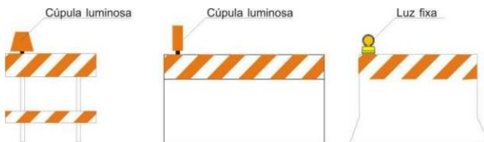
Figura 21 Sinalizações Complementares - Cavaletes de Barragens
