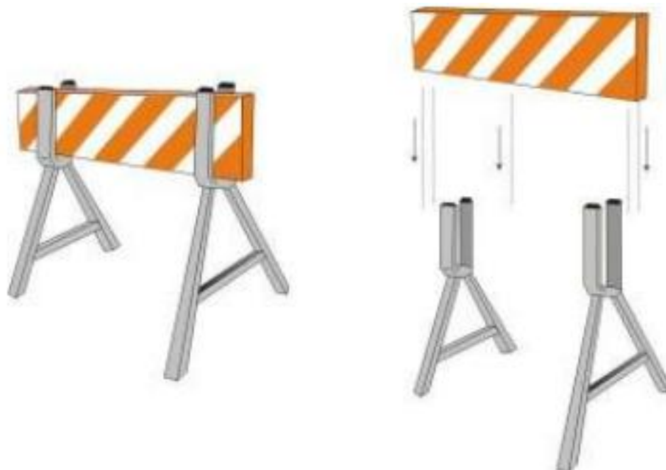
Figura 18 Sinalizações Complementares - Cavaletes de Barragens
