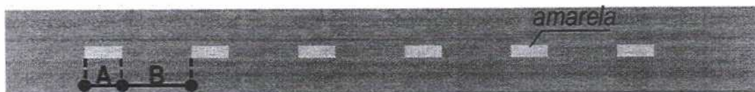
Detalhe Faixa Seccionada.
