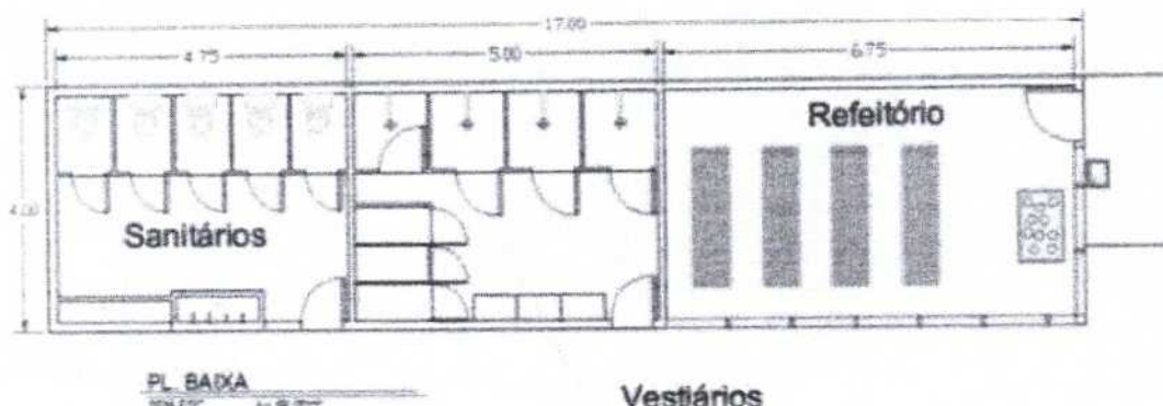
Planta baixa das áreas de vivência: vestiários, sanitários e refeitório
