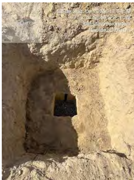
Figura 3 – Execução da cavidade para o ensaio de infiltração
