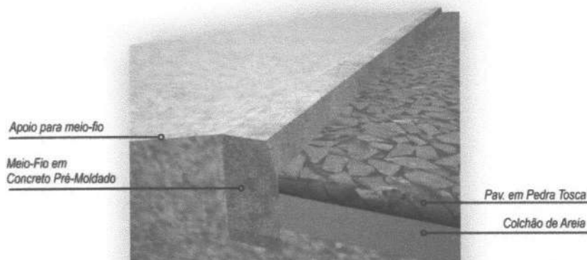
MÉTODO CONSTRUTIVO DE PAVIMENTO EM PEDRA TOSCA SEGUNDO A ESPECIFICAÇÃO DER-ES-P 18/94
