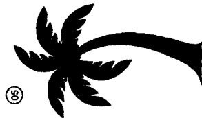
ELEMENTO "COQUEIRO" EM MADERITE OU SIMILAR COM NEON FLEX NO ENTORNO - LAT. ESQUERDA DIMENSÕES: 3,30 x 5,60m 01 UNIDADE
