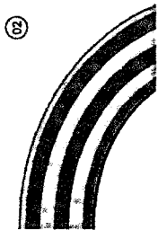
ELEMENTO "ARCO" EM MADERITE OU SIMILAR COM NEON FLEX NO ENTORNO - LAT. DIREITA DIMENSÕES: 5,00 x 7,70m 01 UNIDADE
