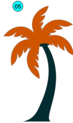
ELEMENTO "COQUEIRO" EM MADERITE OU SIMILAR COM NEON FLEX NO ENTORNO - LAT. ESQUERDA DIMENSÕES: 3,30x5,60m 01 UNIDADE
