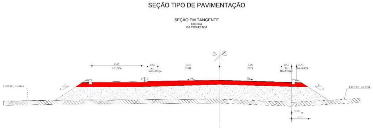
Figura 07 – Largura da Pista da estaca 00 a 162.
