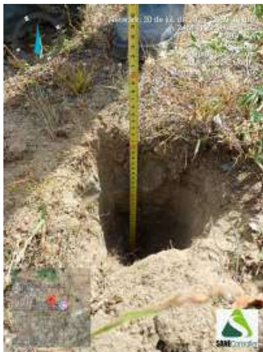
Figura 25 - Indicação da profundidade obtida durante o avanço da sondagem ST-06
