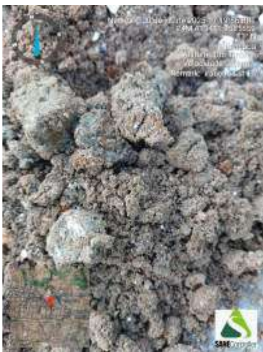
Figura 59 - Indicação da amostra de solo obtida durante a execução da sondagem ST-15
