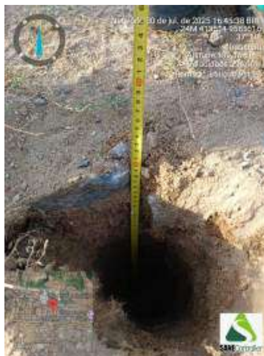
Figura 52 - Indicação da profundidade obtida durante o avanço da sondagem ST-13
