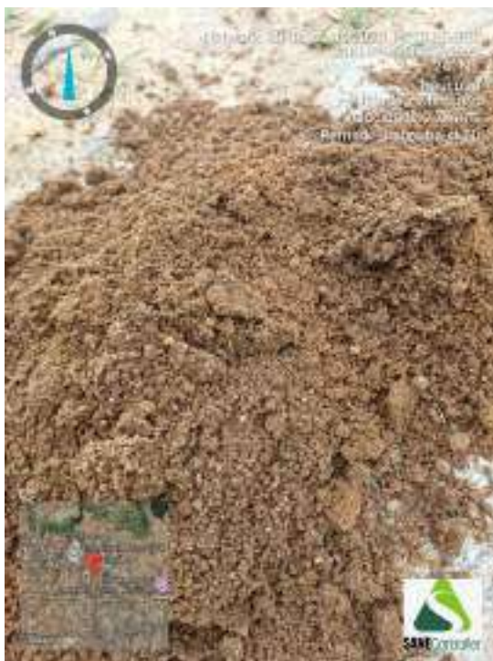
Figura 40 - Indicação da amostra de solo obtida durante a execução da sondagem ST-10
