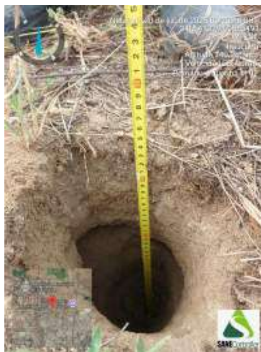
Figura 9 - Indicação da profundidade obtida durante o avanço da sondagem ST-02
