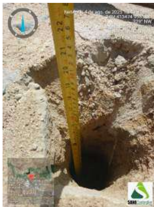
Figura 88 - Indicação da profundidade obtida durante o avanço da sondagem ST-22
