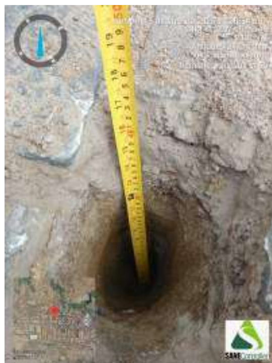
Figura 198 - Indicação da profundidade obtida durante o avanço da sondagem ST-50
