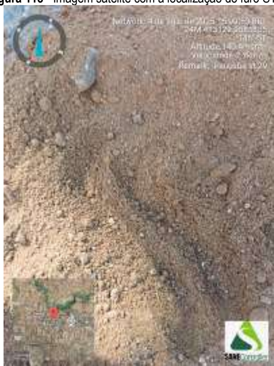
Figura 115 - Indicação da amostra de solo obtida durante a execução da sondagem ST-29
