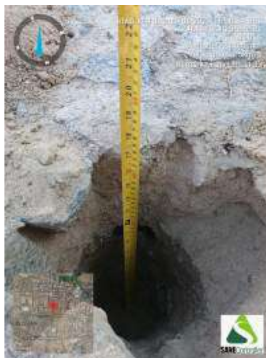
Figura 132 - Indicação da profundidade obtida durante o avanço da sondagem ST-33
