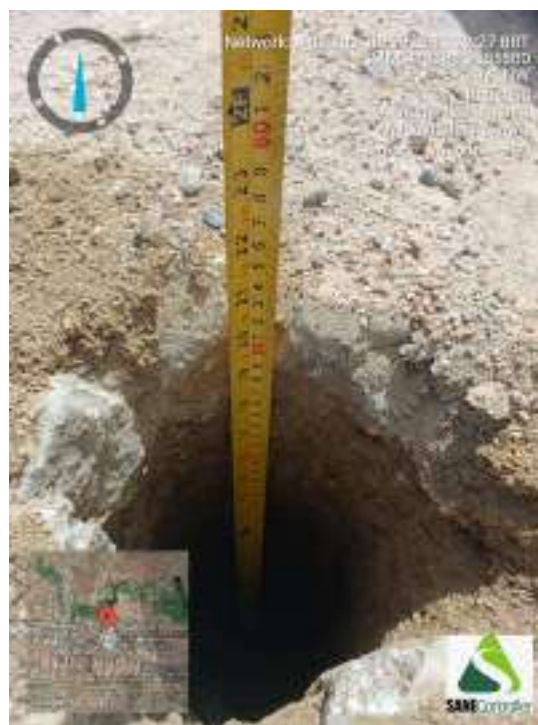
Figura 84 - Indicação da profundidade obtida durante o avanço da sondagem ST-21
