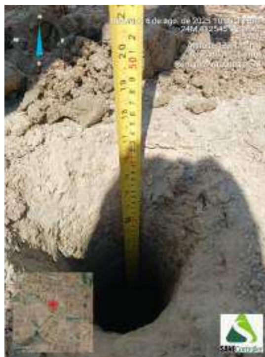
Figura 293 - Indicação da profundidade obtida durante o avanço da sondagem ST-74
