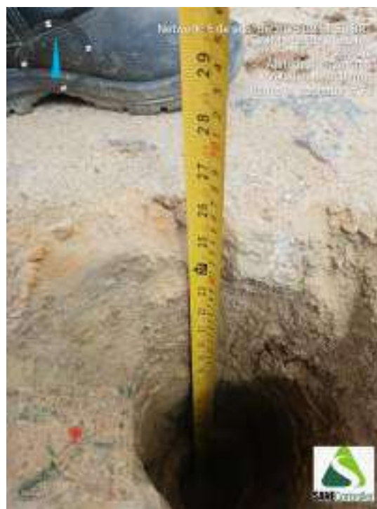
Figura 288 - Indicação da profundidade obtida durante o avanço da sondagem ST-73
