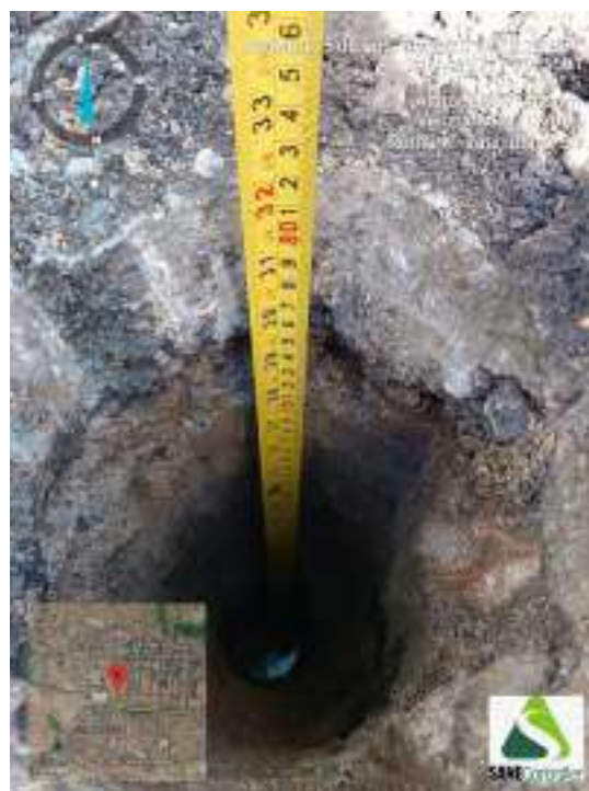
Figura 214 - Indicação da profundidade obtida durante o avanço da sondagem ST-54
