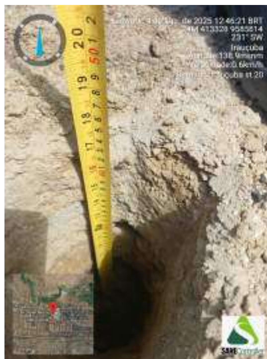
Figura 80 - Indicação da profundidade obtida durante o avanço da sondagem ST-20
