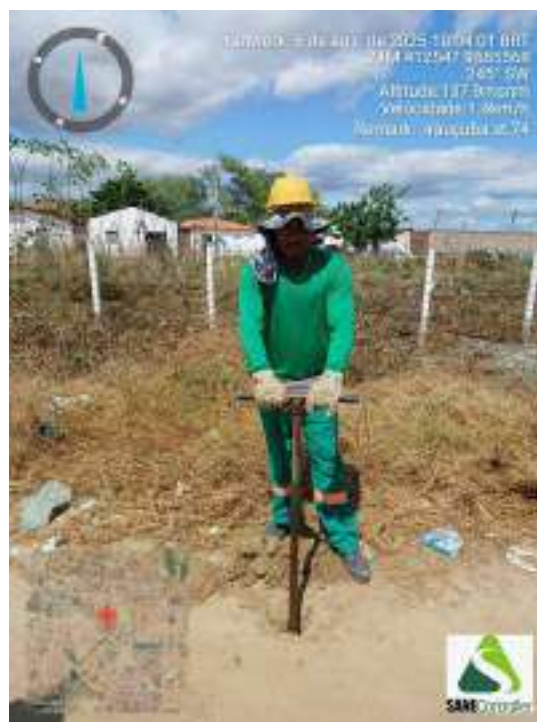
Figura 291 - Detalhe da equipe iniciando a sondagem ST-74
