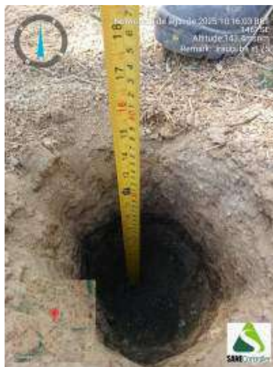
Figura 297 - Indicação da profundidade obtida durante o avanço da sondagem ST-75
