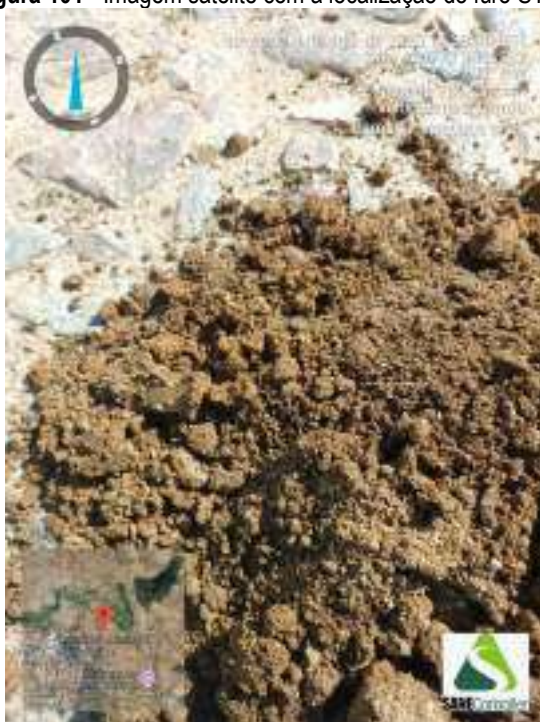
Figura 103 - Indicação da amostra de solo obtida durante a execução da sondagem ST-26
