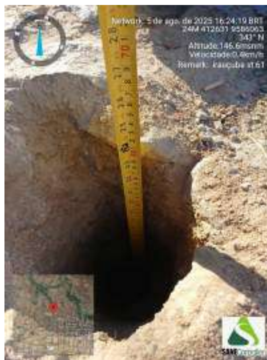
Figura 242 - Indicação da profundidade obtida durante o avanço da sondagem ST-61
