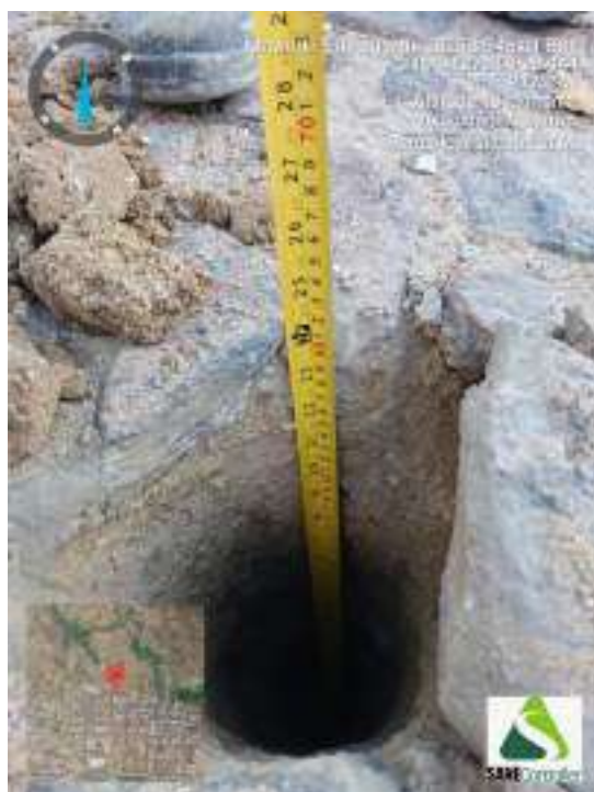
Figura 237 - Indicação da profundidade obtida durante o avanço da sondagem ST-60
