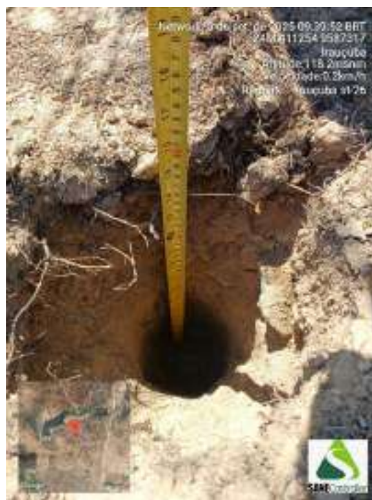
Figura 500 - Indicação da profundidade obtida durante o avanço da sondagem ST-126
