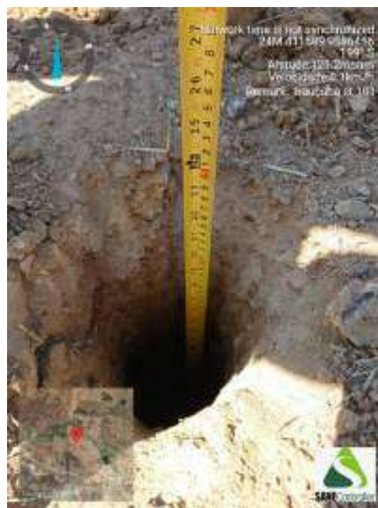
Figura 400 - Indicação da profundidade obtida durante o avanço da sondagem ST-101
