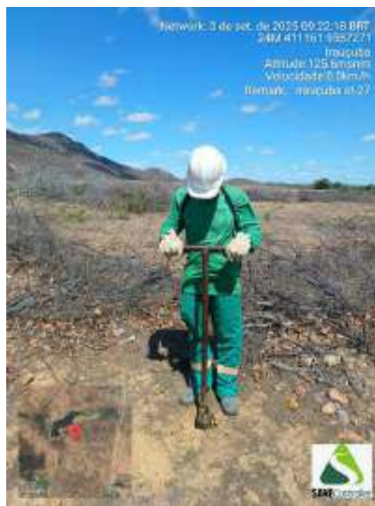
Figura 502 - Detalhe da equipe iniciando a sondagem do ST-127
