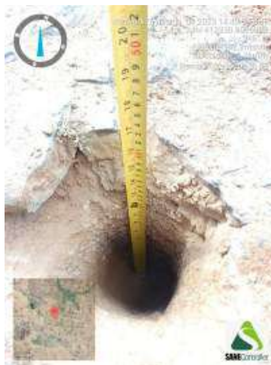
Figura 340 - Indicação da profundidade obtida durante o avanço da sondagem ST-86
