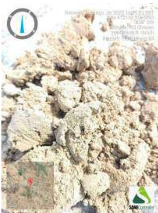
Figura 331 - Indicação da amostra de solo obtida durante a execução da sondagem ST-84
