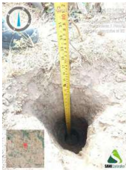
Figura 324 - Indicação da profundidade obtida durante o avanço da sondagem ST-82
