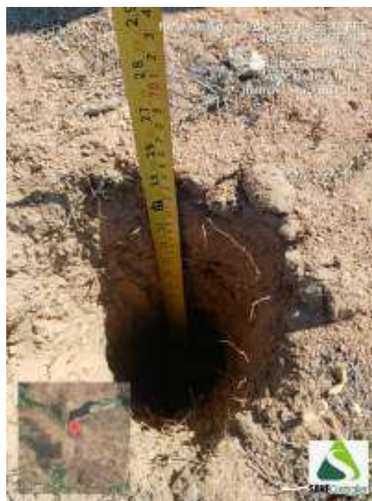
Figura 512 - Indicação da profundidade obtida durante o avanço da sondagem ST-129
