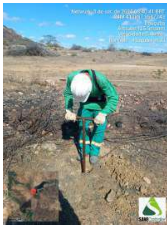
Figura 514 - Detalhe da equipe iniciando a sondagem do ST-130
