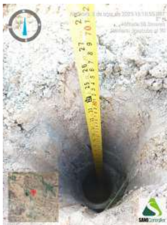
Figura 356 - Indicação da profundidade obtida durante o avanço da sondagem ST-90
