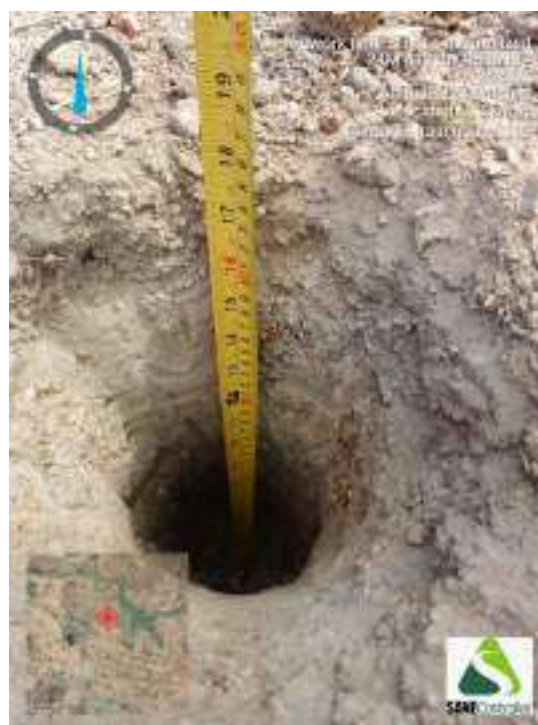
Figura 448 - Indicação da profundidade obtida durante o avanço da sondagem ST-113
