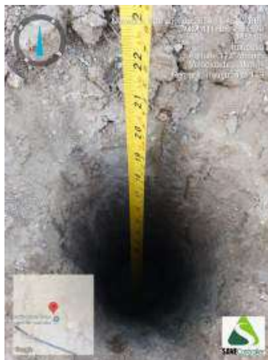
Figura 472 - Indicação da profundidade obtida durante o avanço da sondagem ST-119
