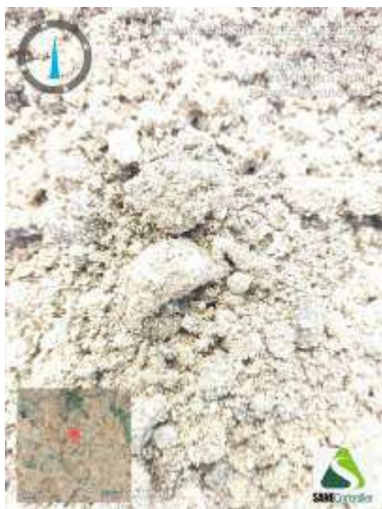
Figura 323 - Indicação da amostra de solo obtida durante a execução da sondagem ST-82
