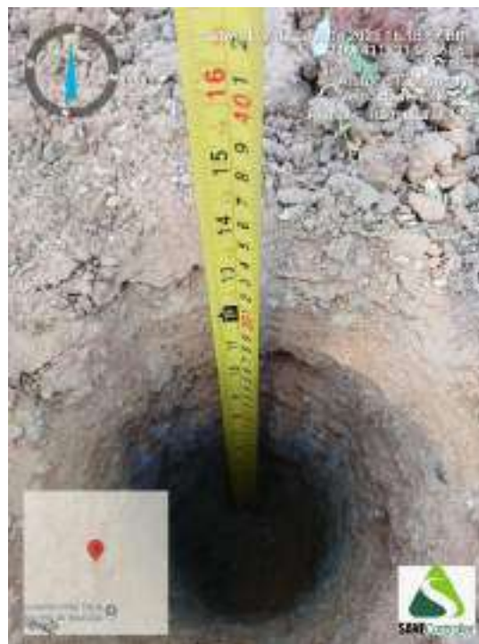
Figura 484 - Indicação da profundidade obtida durante o avanço da sondagem ST-122
