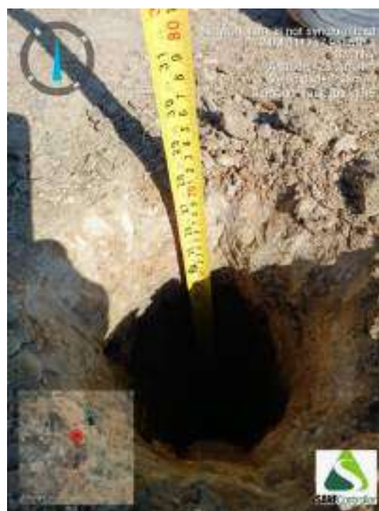
Figura 376 - Indicação da profundidade obtida durante o avanço da sondagem ST-95
