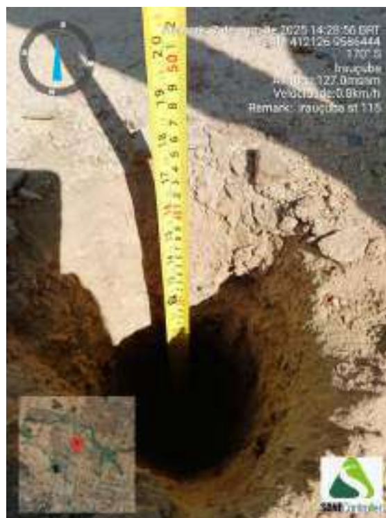
Figura 456 - Indicação da profundidade obtida durante o avanço da sondagem ST-115
