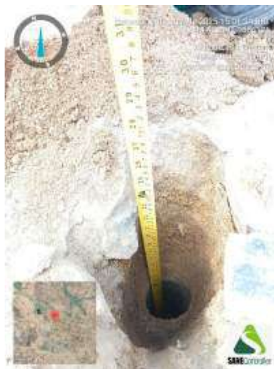
Figura 344 - Indicação da profundidade obtida durante o avanço da sondagem ST-87
