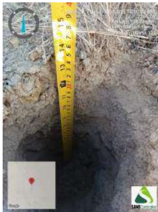
Figura 496 - Indicação da profundidade obtida durante o avanço da sondagem ST-125
