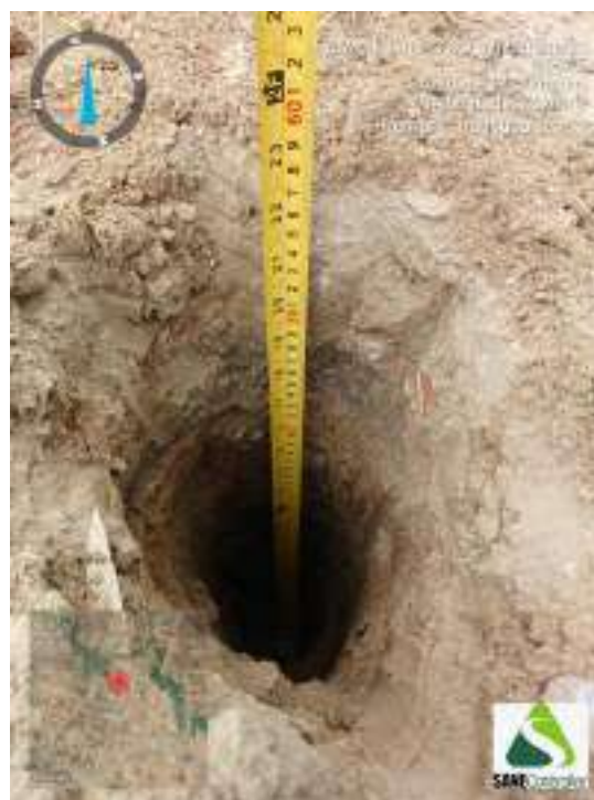
Figura 436 - Indicação da profundidade obtida durante o avanço da sondagem ST-110
