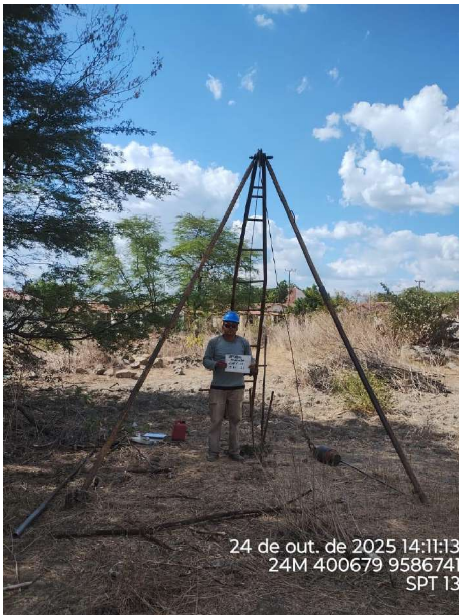
Instalação do furo 2.SPT-13
