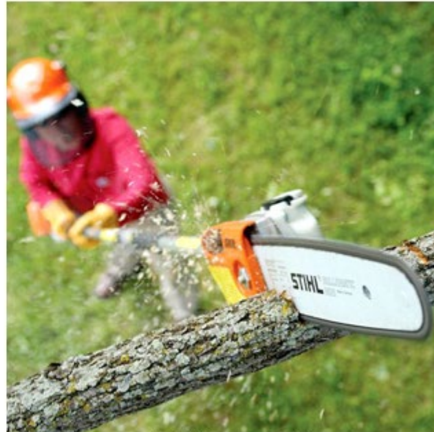
Moto-poda para poda de árvores em altura. Fonte: Stihl (2023).
