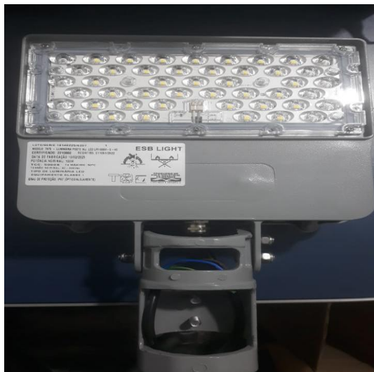
Foto 4 - Amostra de luminária LED 150W
