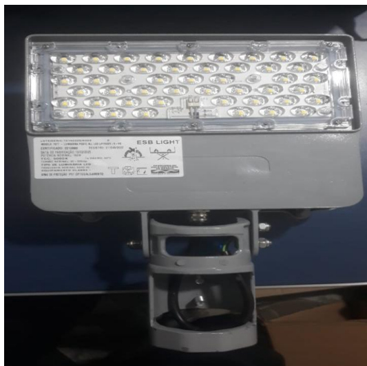
Foto 6 - Amostra de luminária LED 150W
