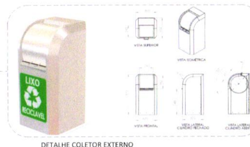
DETALHE COLETOR EXTERNO
