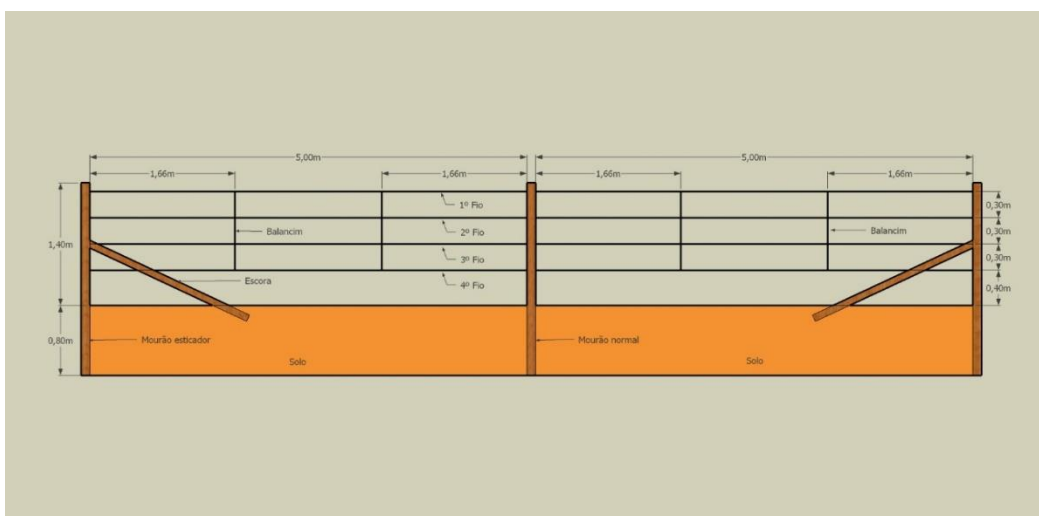
Figura 4 – Sistema e medidas das cercas Tipo 1, para impedir entrada de gado nas áreas do Projeto Produtor de Água do Rio Camboriú.
