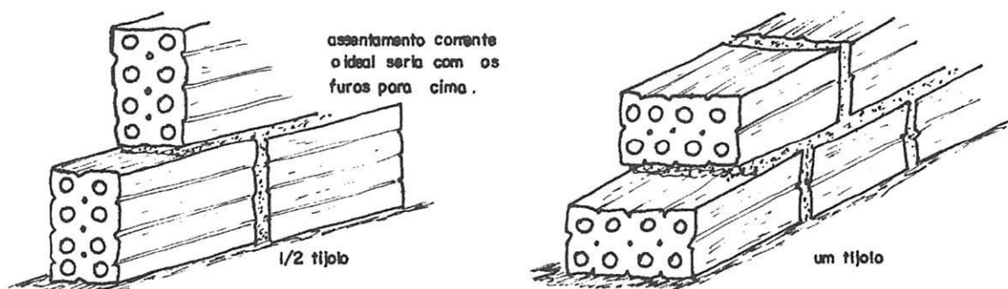
Figura 1 - Execução de alvenaria utilizando tijolos furados.
