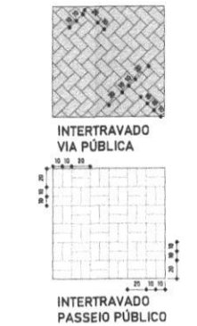
3 DET. DA PAVIMENTAÇÃO Escala - 1:25
