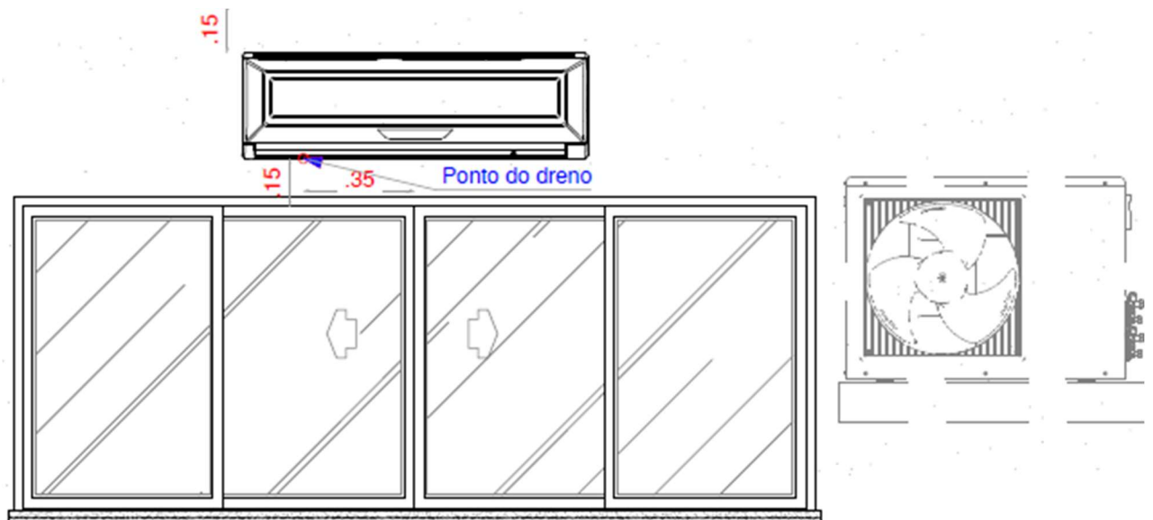
Figura 8 - Indicação de ponto do dreno do ar-condicionado.
