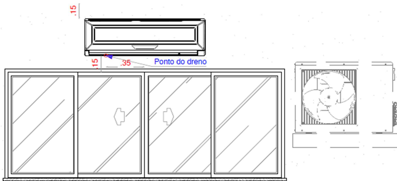
Figura 8 - Indicação de ponto do dreno do ar-condicionado.
