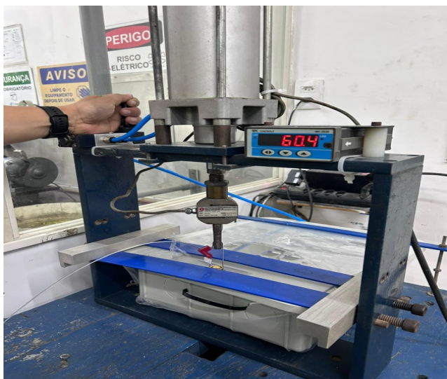
Fotos 3 a 6 – Imagens das amostras dos lacs durante ensaio de tração.
