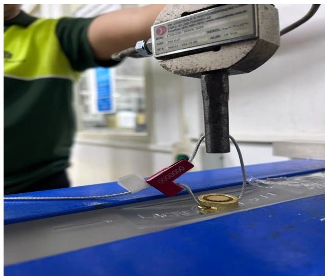
Fotos 3 a 6 – Imagens das amostras dos lacs durante ensaio de tração.
