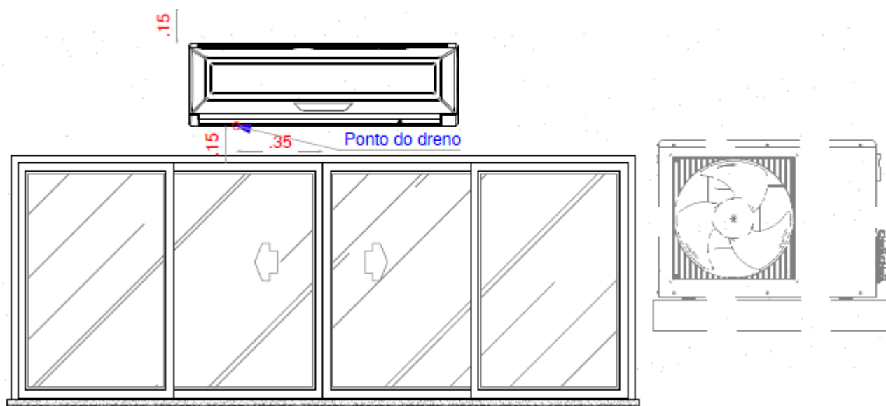
Figura 8 - Indicação de ponto do dreno do ar-condicionado.
