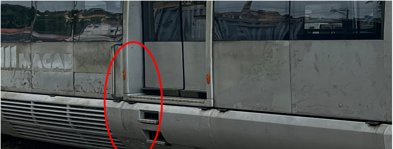
Figura 7 – Pega-mão da porta do maquinista. Fonte: Arquivo Metrofor.
