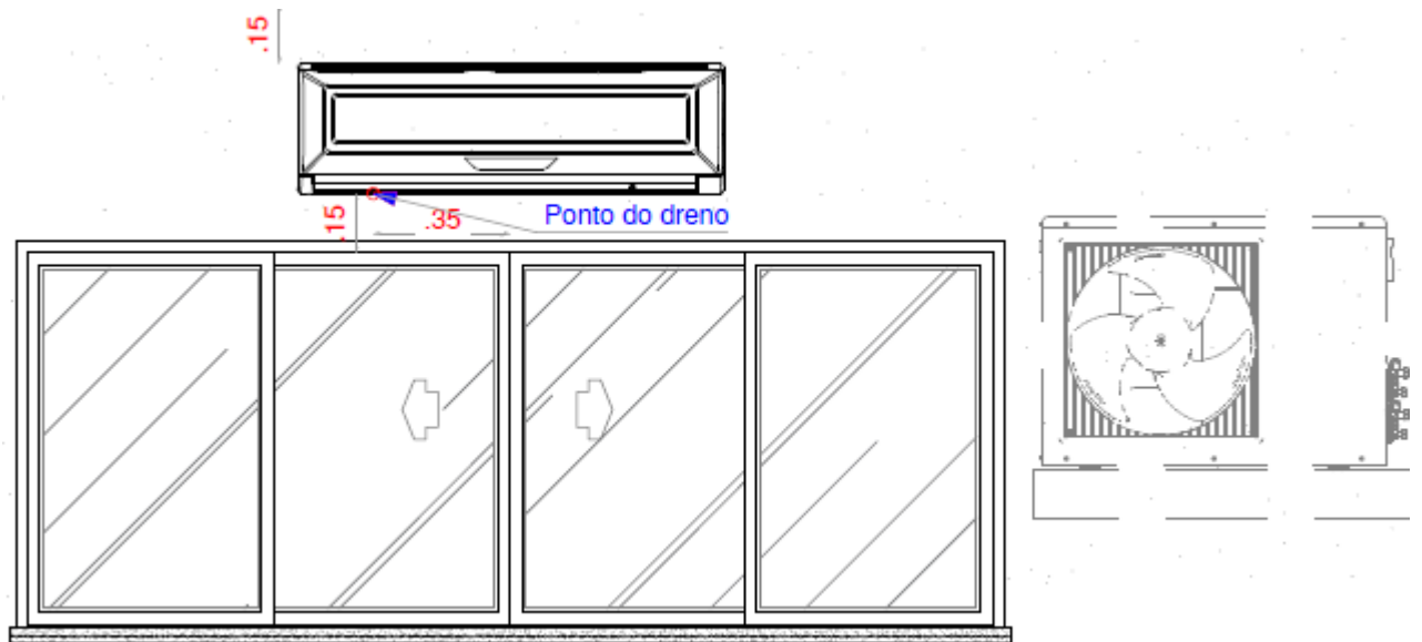
Figura 8 - Indicação de ponto do dreno do ar-condicionado.
