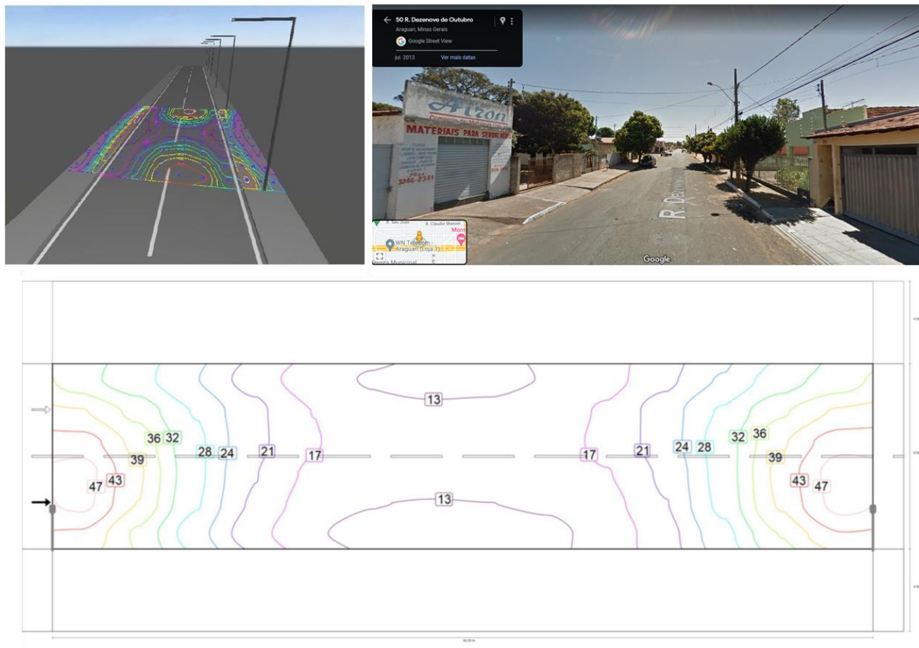
Figura 9 – Planta Esquemática Posteação Unilateral
