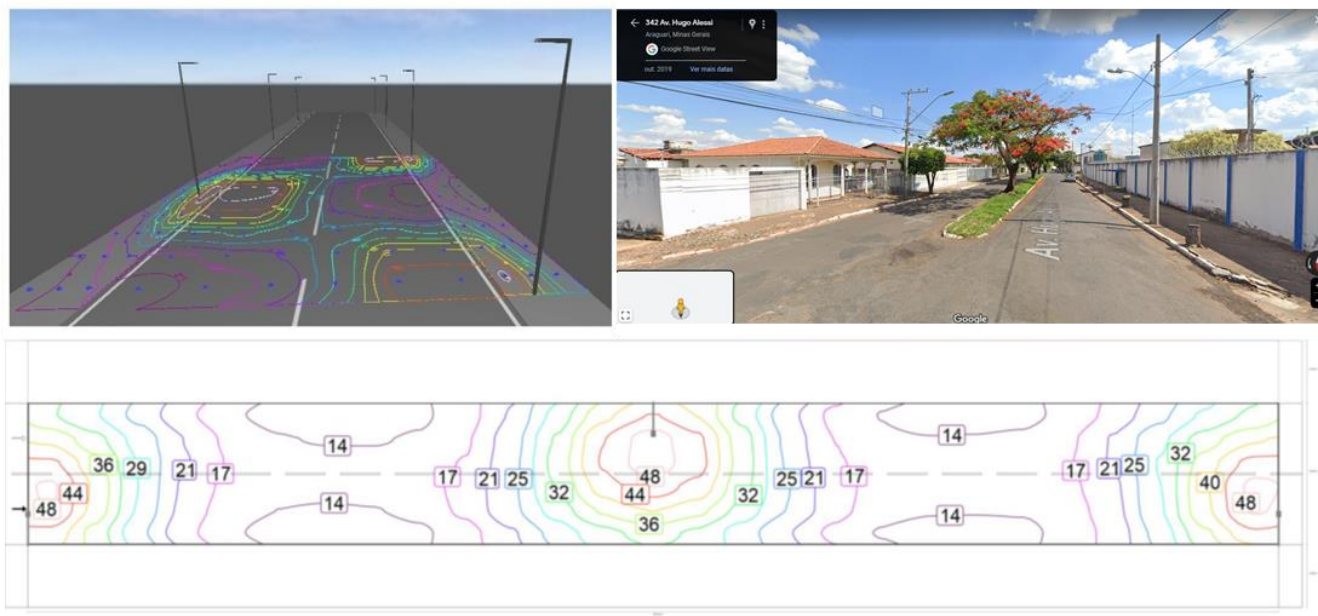
Fonte: Google Maps e Dialux, elaboração MODELO IP. Figura 12 - Planta Esquemática Posteação Bilateral Frontal
