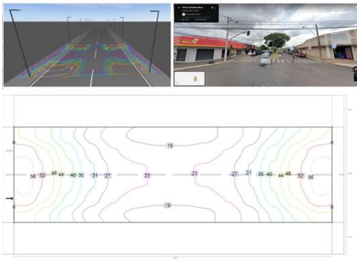
Fonte: Google Maps e Dialux, elaboração MODELO IP. Figura 12 - Planta Esquemática Posteação Bilateral Frontal
