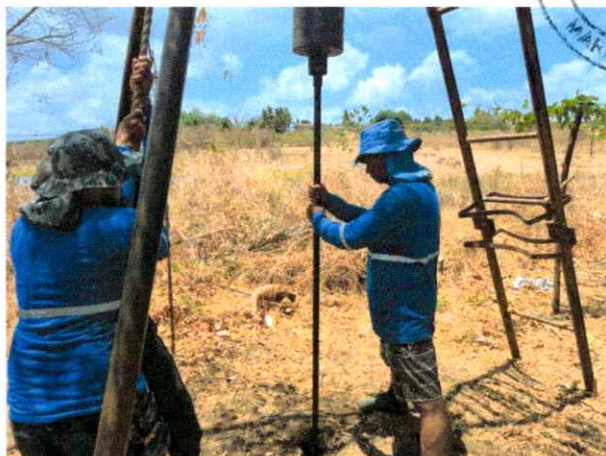
Foto 2 – Detalhe da operação de cravação do amostrador padrão para obtenção do "SPT" do terreno de fundação.
