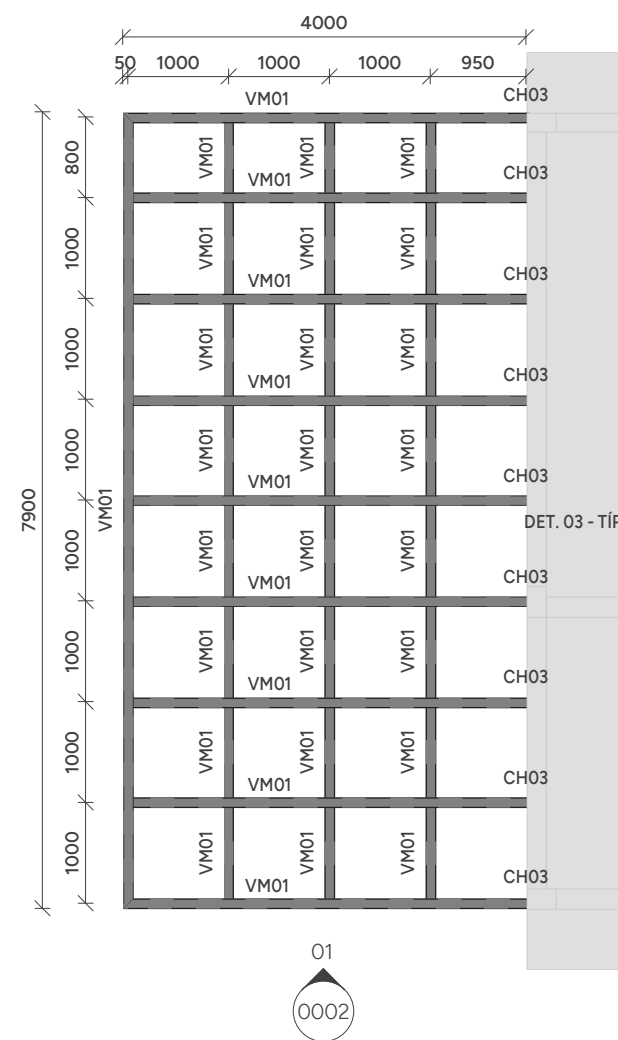
PLANTA DE PERGOLADO - NÍVEL 4,18m - T.V.A.
