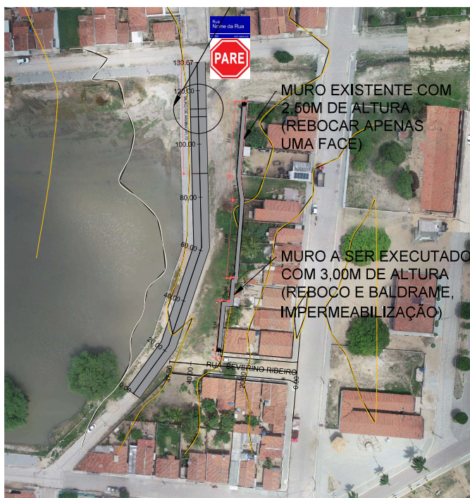
PLANTA DE SITUAÇÃO E LOCAÇÃO ESCALA.....1/500
