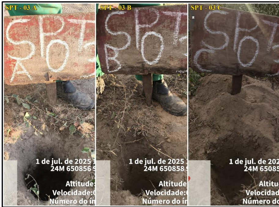
Figura 03: Execução das sondagens à percussão – SPTs (03). Fonte: Foco Geosoluções, 2025
