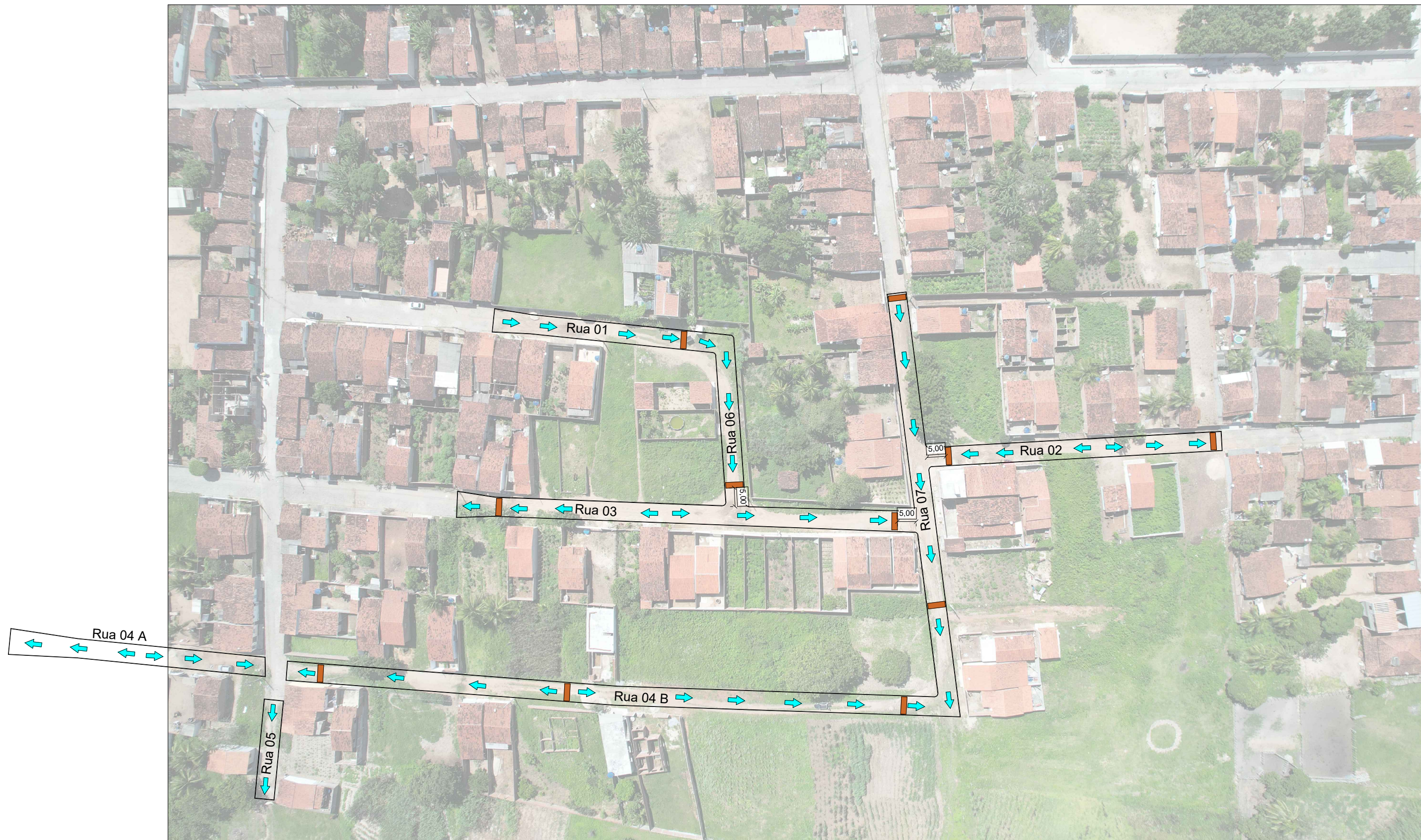
Planta fluxo de drenagem superficial e lombadas
