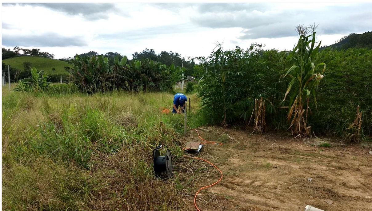
Fotografia 2 - Instalação dos cabos multieletródos na linha L 2 (S-4).
