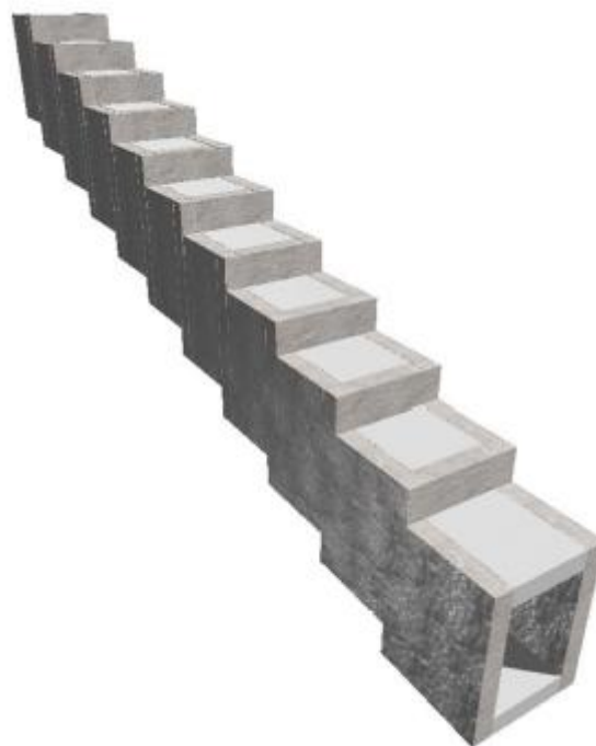
Figura 6 - Escada hidráulica fechada
