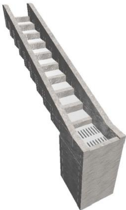
Figura 5 - Escada hidráulica aberta
