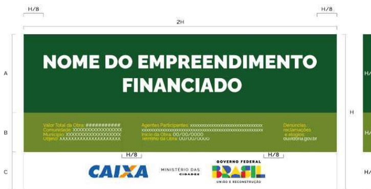
Figura 1: Padrão geral da placa de obras - Leiaute. Manual de Placas e Adesivos de Obras.
