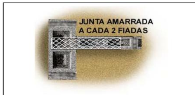
Figura 7: Junta com tela de aço entre alvenarias
