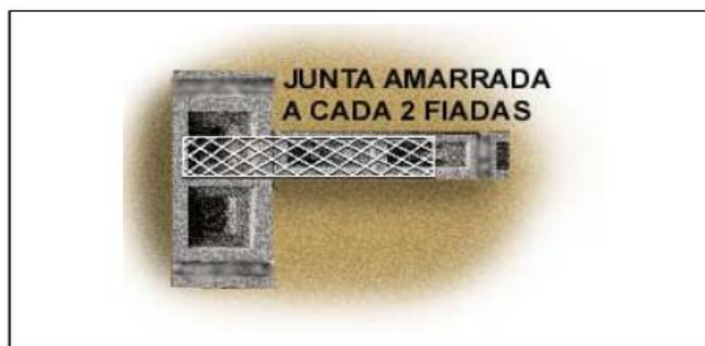
Figura 7: Junta com tela de aço entre alvenarias
