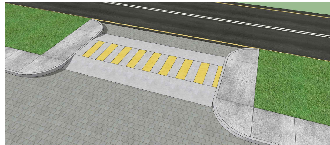
PERSPECTIVA 3D - PASSAGEM ELEVADA TIPO QUEBRA MOLAS COM FAIXA DE PEDESTRE RUA ANTONIO NORBERTO DE OLIVEIRA (ANTONIO PEDRA) ESCALA - 1 / 50
